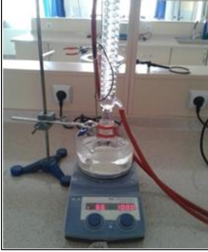
Şekil 1. Transesterifikasyon tepkimesi deney düzeneği
